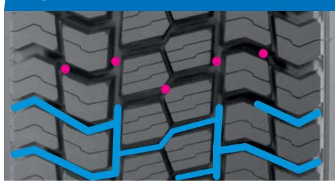
Recutting width / Šírka prerezania / Nachprofilierungsbreite
