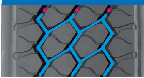
Recutting width / Šírka prerezania / Nachprofilierungsbreite
