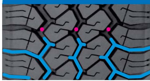
Recutting width / Šírka prerezania / Nachprofilierungsbreite
