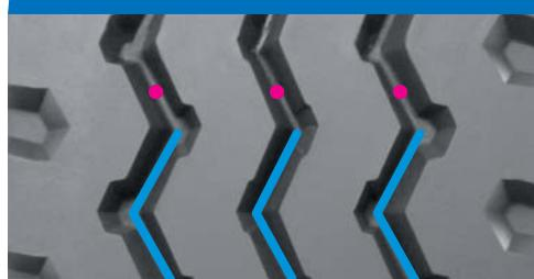
Recutting width / Šírka prerezania / Nachprofilierungsbreite
