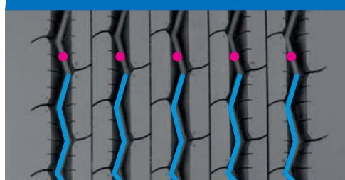
Recutting width / Šírka prerezania / Nachprofilierungsbreite
