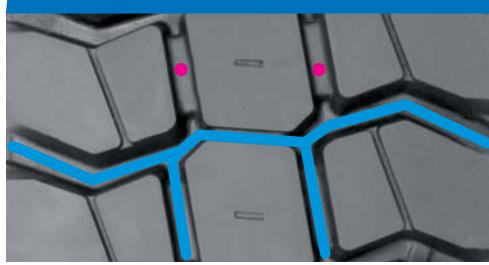
Recutting width / Šírka prerezania / Nachprofilierungsbreite
