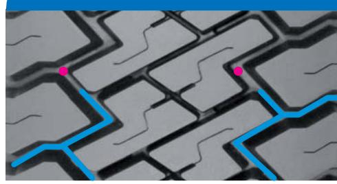
Recutting width / Šírka prerezania / Nachprofilierungsbreite
