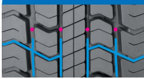
Recutting width / Šírka prerezania / Nachprofilierungsbreite
